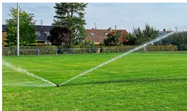
Moderne Getrieberegner mit einer reduzierten Geräusentwicklung ermöglichen die Bewässerung in den frühen Morgenstunden.
